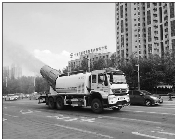
因夏季高温干燥容易引起扬尘,山东省济南市槐荫区加大多功能抑尘车使用频次,对城区道路进行巡回喷雾降尘。 王学鹏摄
