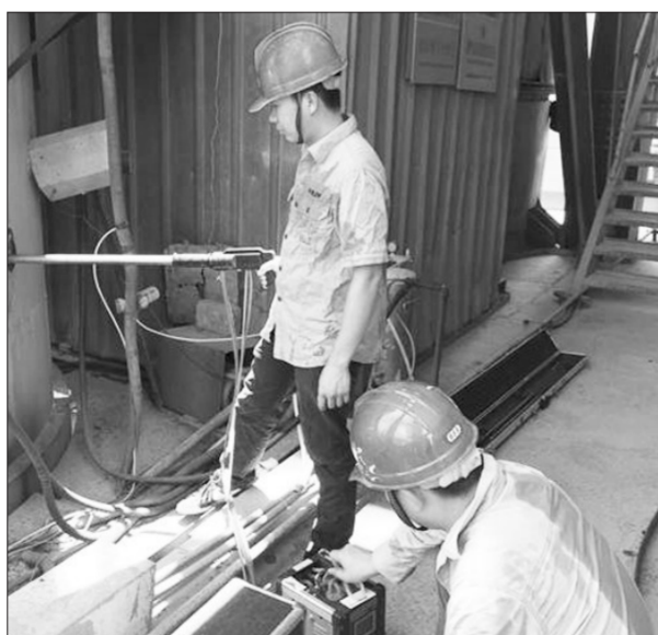
环境监测人员冒着高温酷暑把采样枪插入烟气取样孔,汗水浸透了衣襟。
