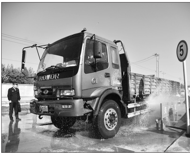
为加大大气污染防治力度,北京市密云区加大管控制度并规定施工工地大型车辆上路,必须经过自动冲洗监控系统,以确保施工工地车辆降尘、清洁上路。
