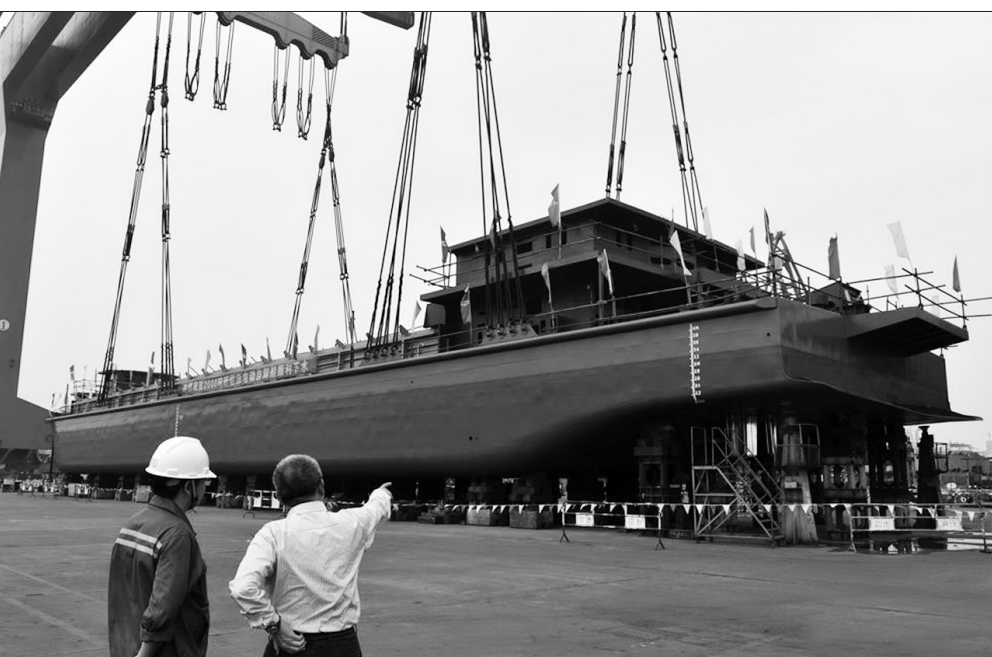
世界第一艘2000吨级纯电池推动重载船舶近日在广东省广州南沙龙穴岛成功下水。这艘船是采用锂电池作为全船动力的内河货运船舶,充电2.5小时,在满载情况下续航力可达80公里,实现碳、硫及PM 2.5 颗粒等污染物零排放。下水仪式上,国内第一个新能源电动船舶产业标准化联盟标准同步发布。
