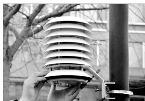
泛测环境自主研发的智能化微型空气质量传感监测仪。
