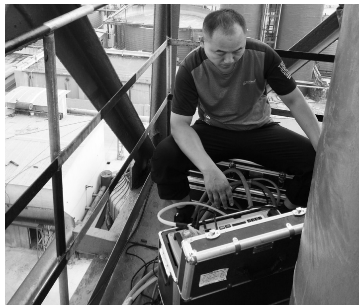
为保障辖区环境空气质量,山东茌平县环保局不断加强环境监管,开展主要污染源排放人工监测,严厉打击偷排偷放、超标排放等环境违法行为。图为茌平县环境监测人员顶着酷暑高温,在高空监测平台上进行固定污染源排气筒废气采样监测。
