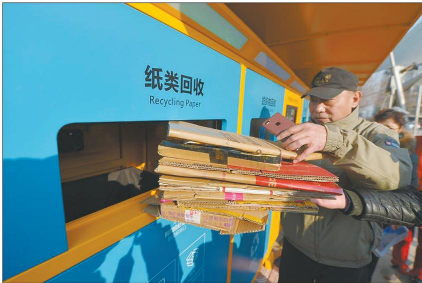
山东省青岛市合肥路街道的人工智能垃圾分类终端机日前投入使用。这一设备通过手机APP、输入手机号、微信扫码等方式,分别回收金属、塑料、纺织物、纸类、玻璃、有害等多种生活垃圾,并有实时反馈功能,还有红包奖励,鼓励居民垃圾分类,提高再生资源回收利用效率。 中国日报图片网供图
