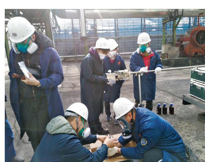
为进一步掌握陕西省煤化工行业特征污染变化趋势,研究其特征污染对人体健康的影响,陕西省环境科学研究所和大气环境研究所的工作人员正在监测现场安装采样设备,校正监测仪器。
