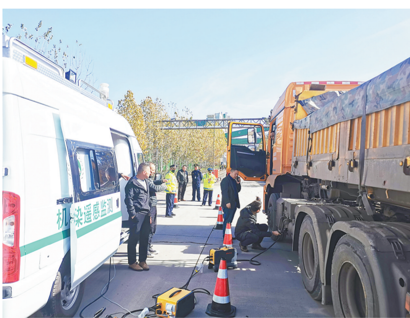
河南省三门峡市生态环境局第二分局近日开展2019年~2020年秋冬季重点场所重型柴油车入户抽检抽测工作,利用机动车遥感监测系统,对重点企业的车辆尾气进行监测,确保重点企业柴油车等机动车尾气达标排放。 赵岩供图
