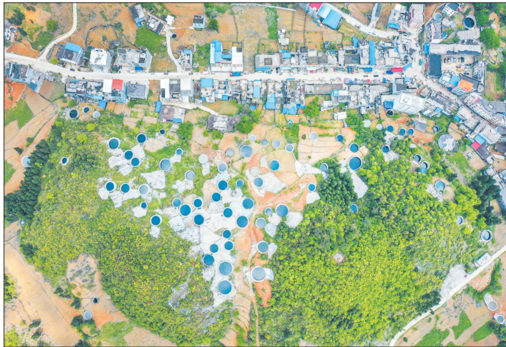
近年来,广西壮族自治区河池市凤山县通过实施大石山区人畜饮水工程大会战、特困村综合治理大会战、农村饮水安全大会战等,大力扶持帮助群众建设家庭水柜(即水柜)。目前,全县已建成家庭水柜3.5万座,大石山区每户有一座以上水柜,实现农村饮水安全保障全覆盖。 人民图片网供图
