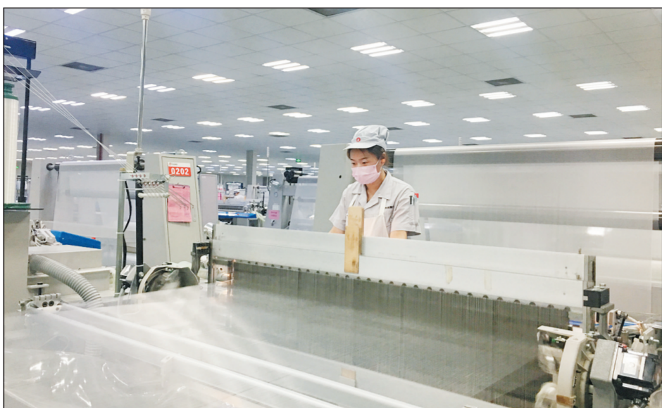
河南光远新材料股份有限公司的生产线正在织出“薄如蝉翼”的电子纱。
