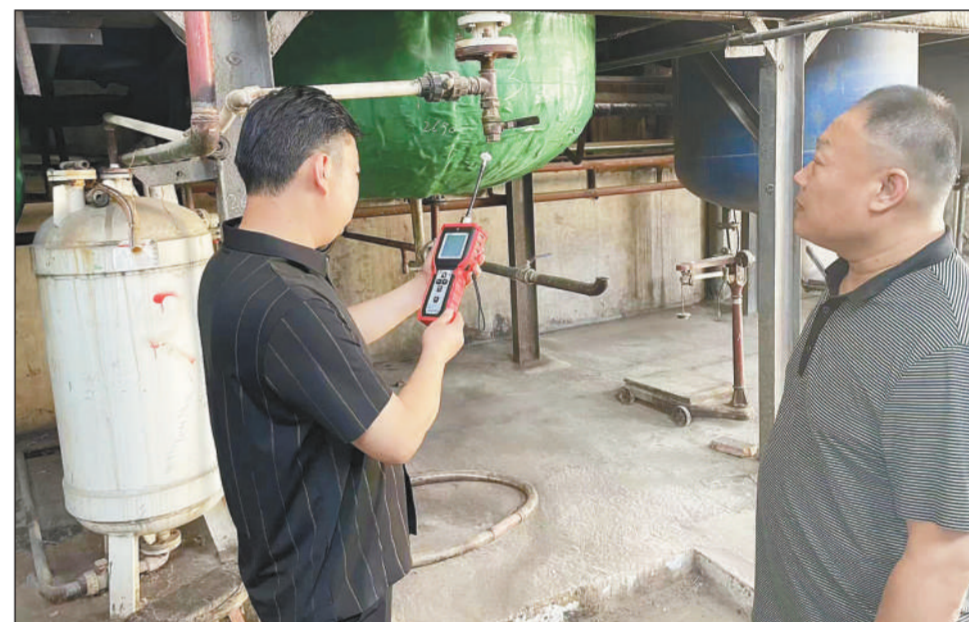
近段时间,河南省新乡市天气异常炎热,室外气温高达39℃。为积极预防夏季臭氧污染,新乡市生态环境局原阳综合行政执法大队大队长张海洋与副大队长王文喜带队到辖区企业开展针对性指导帮扶。图为执法人员正在使用PID检测仪对企业进行抽检。李海永摄
