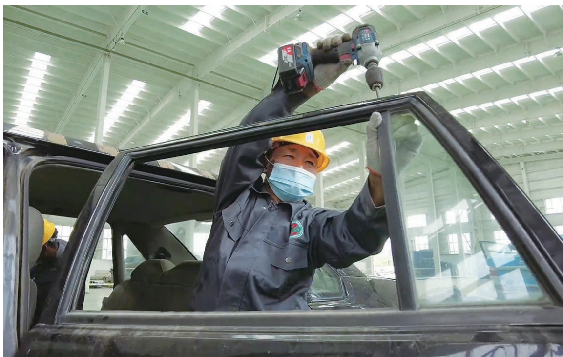
在新疆维吾尔自治区伊犁物资回收有限公司下属的报废机动车回收分拣中心,工作人员正在对一辆报废汽车进行拆解。 林海摄
