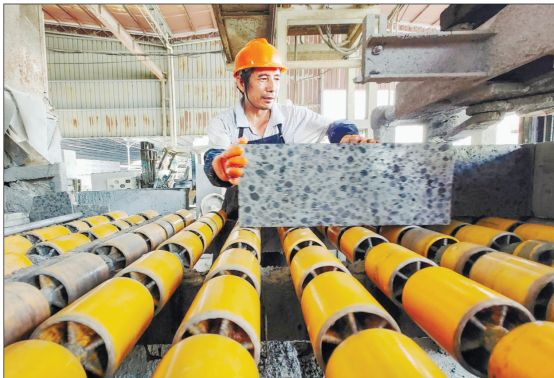
近年来,浙江省宁波市积极探索建筑垃圾资源化再利用,把建筑渣土和废弃混凝土等作为原材料,制作空心砖、烧结墙板、复合保温砌块和保温陶粒砌块,实现循环利用、变废为宝,既从源头压缩了企业生产成本,又切实解决了建筑垃圾消纳处置难题。图为宁波市平海建材有限公司的员工利用渣土和废弃混凝土等加工生产保温陶粒砌块。
